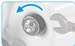
Uvoľnite 4 prepravné skrutky pomocou kľúča.
