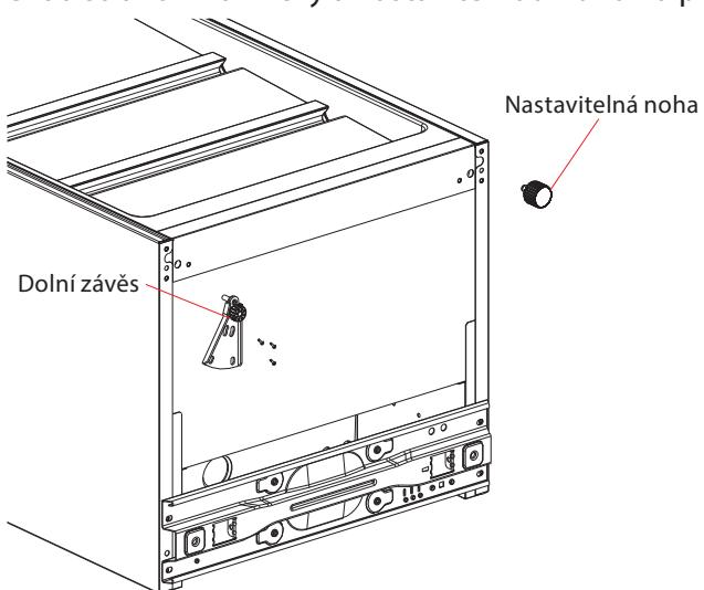
7. Nasaděte dveře na dolní závěs a zkontrolujte, zda těsnění správně těsní a poloha dveří je správná. Namontujte levý horní závěs a nasaděte na závěs krytku (dodáno jako příslušenství). Nakonec nasaděte krytku na otvory pro pravý horní závěs.
