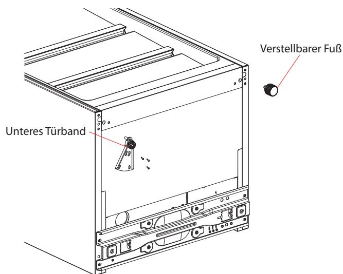
7. Setzen Sie die Tür auf das untere Türband auf und überprüfen, ob die Dichtung richtig anliegt und die Tür gut schließt. Montieren Sie das linke obere Türband an und setzen die Abdeckung auf (Bestandteil des Zubehörs). Die Abdeckung gehört auch auf die rechten oberen Türbandlöcher.
