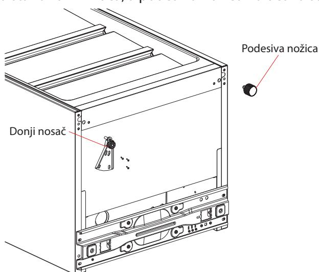
7. Postavite vrata na donji nosač i provjerite je li brtvljenje ispravno i stoje li vrata u pravilnom položaju. Postavite lijevi gornji nosač i postavite poklopac na nosač (poklopac je isporučen kao pribor). Na kraju postavite poklopac na otvore za desni gornji nosač.
