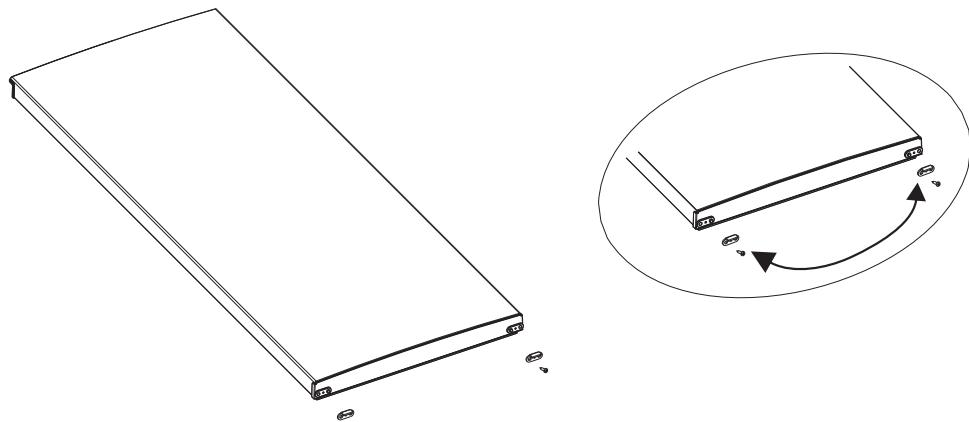
5. Demontieren Sie das untere Türband und den verstellbaren Fuß.
