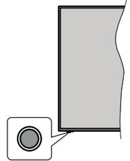
**Abschalten des Fernsehers:** Drücken Sie die Steuertaste, um das Menü mit den Funktionsoptionen aufzurufen, der Fokus befindet sich dann im Standby-Modus. Halten Sie die Taste 2 Sekunden lang gedrückt, um diese Option zu aktivieren. Die Farbe des Optionssymbols ändert sich, wenn Sie die Option aktivieren. Drücken Sie die Taste erneut, um das Fernsehgerät auszuschalten.
