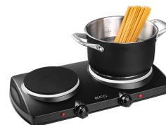
Die Gesamtleistung des Herdes beträgt 2500 W (1500 + 1000 W). Sie können bei beiden Kochzonen 5 Leistungsstufen einstellen, die Sie einfach mit zwei Drehwählern regeln können. Die maximale Betriebstemperatur der größeren Kochzone beträgt 450 °C. Die kleinere Kochzone erreicht eine Temperatur von 350 °C (±50 °C).
